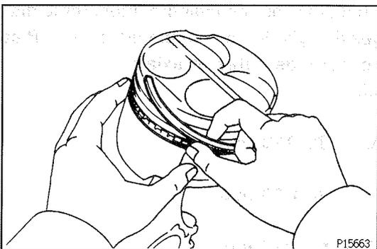
(b) Retirer les deux expandeurs et l'expandeur de segment racleur d'huile à la main.
